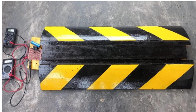
Gambar 4. Rangkaian Pengujian Prototipe Speed Bump (Polisi Tidur) Memanfaatkan Piezoelectric
